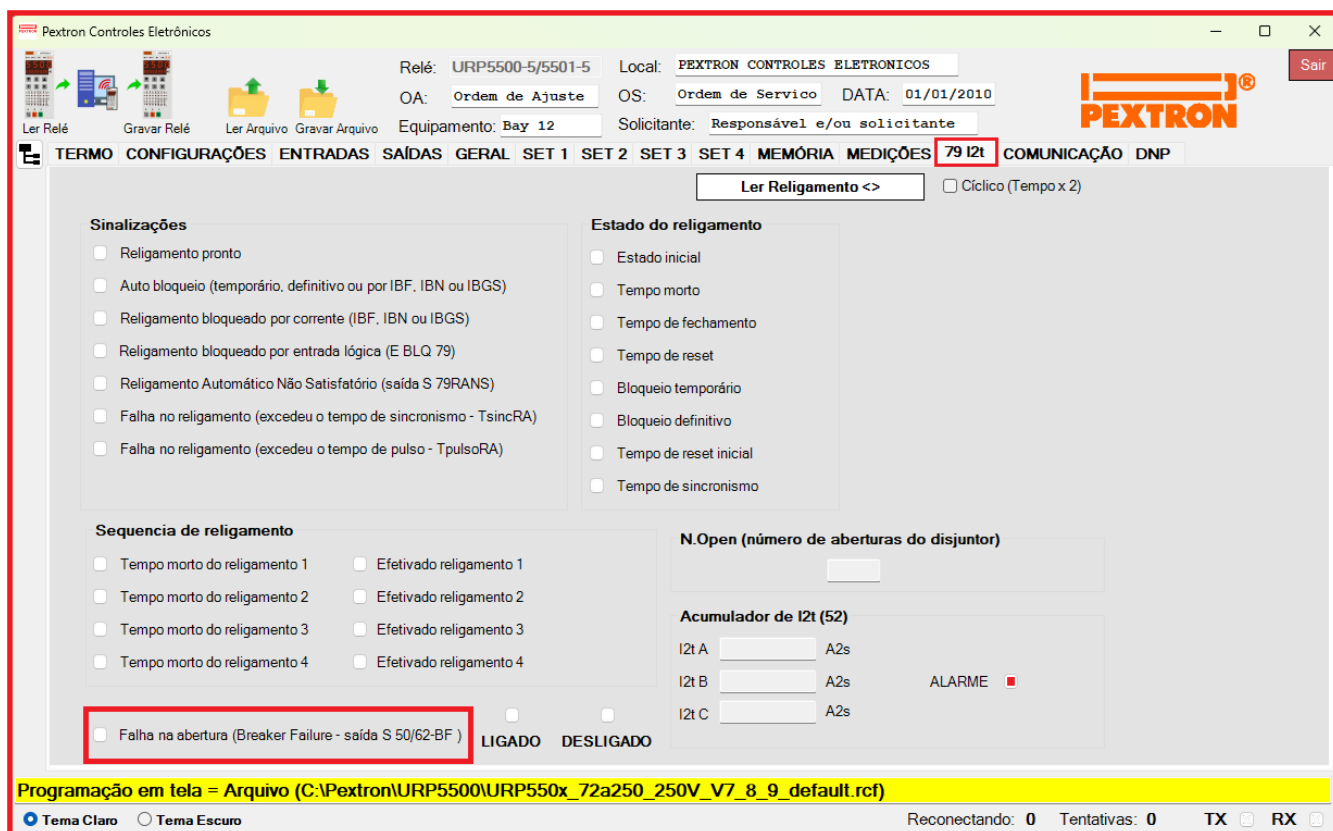
Figura 17.2: Pasta 79 I2t do programa aplicativo sinalizado com indicação do estado de falha do disjuntor.
